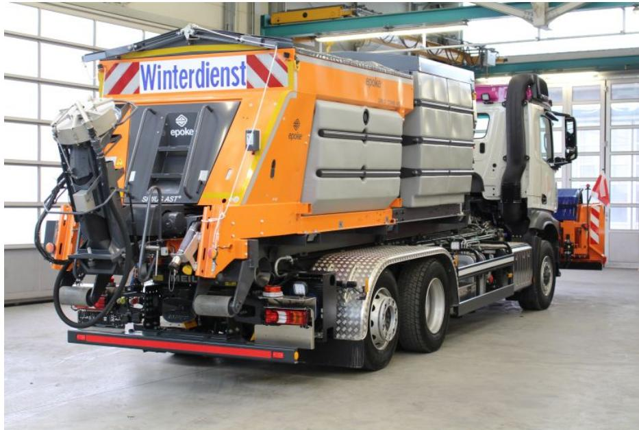
F&B hat jahrelange Erfahrung in der fahrgestelltechnischen Anpassung sowie kommunaltechnischen An- und Aufbauten. Hier ein Epoke-Streuautomat auf Schnellwechselsystem mit Hakenlift.
