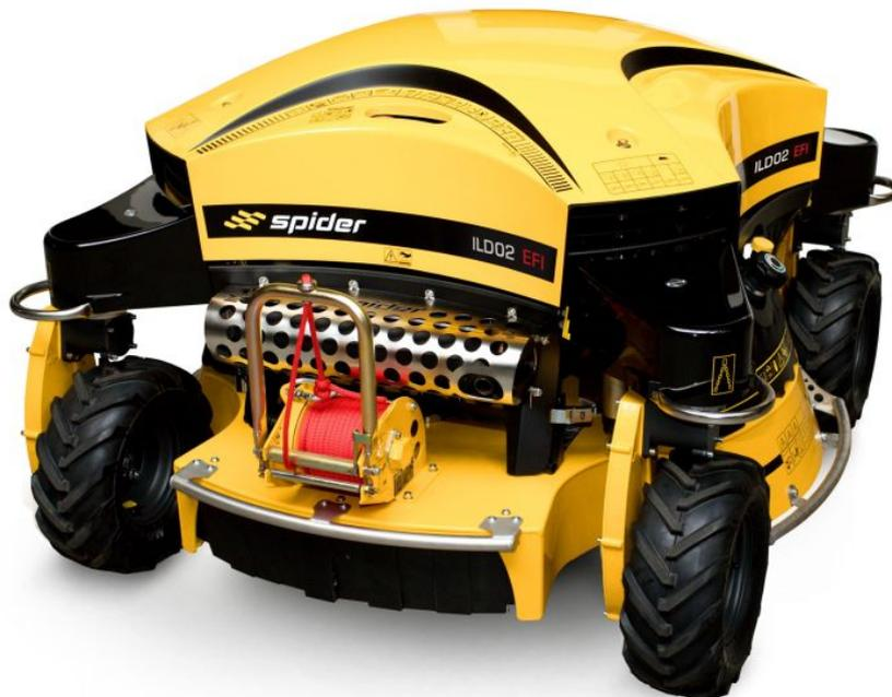
Die Arbeitssicherheit des »Spider« kann zusätzlich mit einer hydraulischen Seilwinde erhöht werden, die eine Stabilität der Maschine auch in extremen Hanglagen gewährleistet (Bild: Rumsauer).
