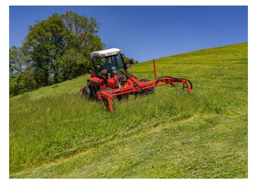
Der Heckmotor des Hangmähers sorgt gute Balance.
