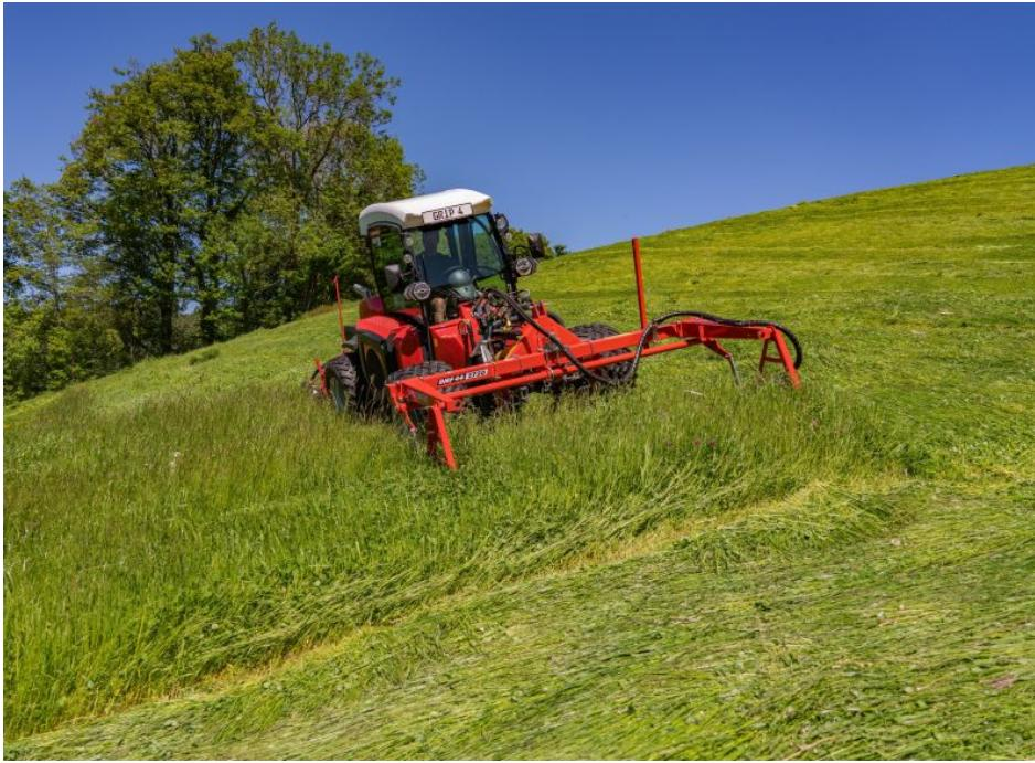
Der Heckmotor des Hangmähers sorgt gute Balance.
