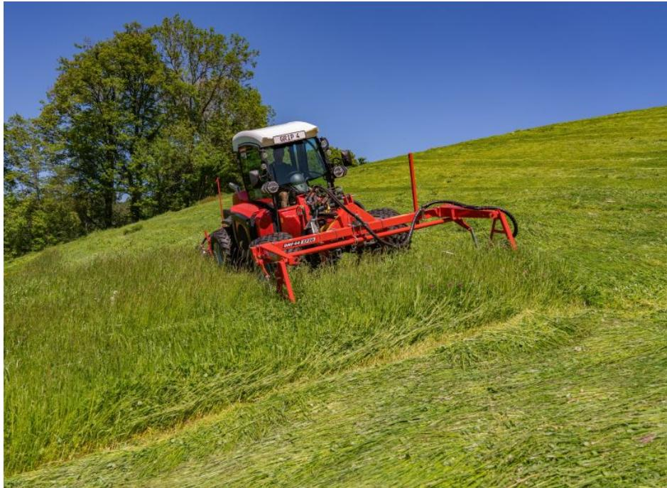
Der Heckmotor des Hangmähers sorgt gute Balance.
