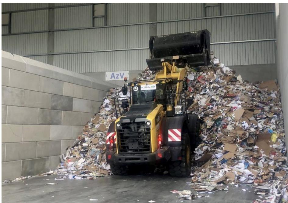
Der Komatsu WA380-8 ist zum Aufladen und Umladen von Recyclingmaterial bis zu neun Stunden täglich im Einsatz (Bild: Kuhn Baumaschinen).
