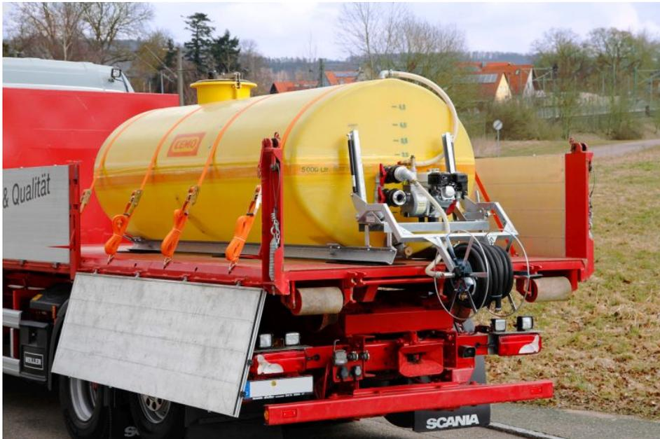
Abgestimmte Produkte für die Bewässerung nach Maß: kleine und große Tanks, Behälter mit optionalem Zubehör wie Pumpen und Schläuche (Bild: Cemo)
