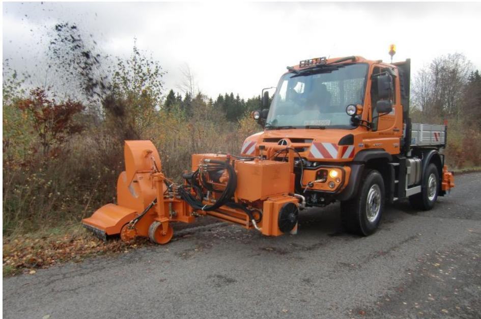
Unimog mit leistungsstarker Randstreifenfräse BF 600 von AS Baugeräte (Bilder: Sauer Bibus).
