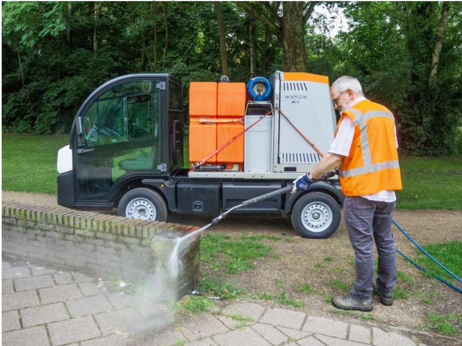
Unkrautentfernung mit dem Heißwassersystem »MCB-30« auf einem Geräteträger (Bild: Empas).
