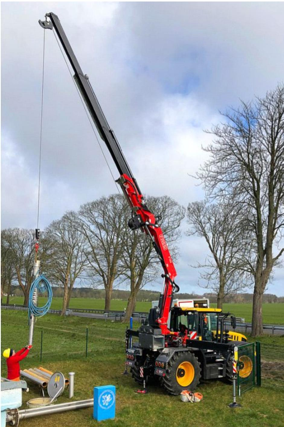
Die maximale Reichweite des F135 liegt bei 10,35 m (Bilder: Fassi Ladekrane GmbH).
