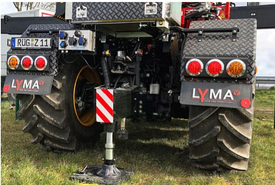
Eine dritte Abstützung gewährleistet zusammen mit einem vorn am Fahrzeug angebrachten Kontergewicht über 360 Grad hundert Prozent Standsicherheit des Krans.
