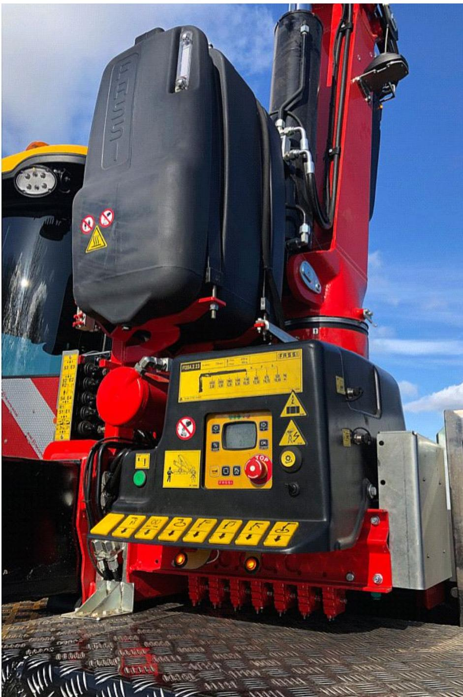
Sämtliche Elektronikkomponenten rüstete der Kranspezialist auf die bei Traktoren übliche Bordspannung von 12 V um.
