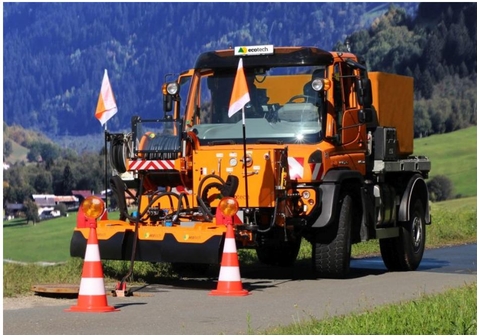
Besonders nach Unwettern werden mit dem ecotech Kanalspülgerät KSG Verunreinigungen aus Rohren, Rinnen und Wasserdurchlässen an Straßen beseitigt (Bild: Eco Technologies).
