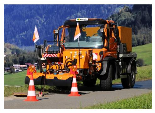
Besonders nach Unwettern werden mit dem ecotech Kanalspülgerät KSG Verunreinigungen aus Rohren, Rinnen und Wasserdurchlässen an Straßen beseitigt (Bild: Eco Technologies).
