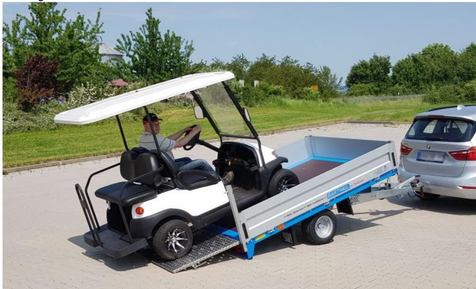
Für mehr Ladefläche, mehr Sicherheit und eine schnelle Verladung steht der Typ »ET« selbstkippend mit Ladungssicherung (Bild: Barthau).
