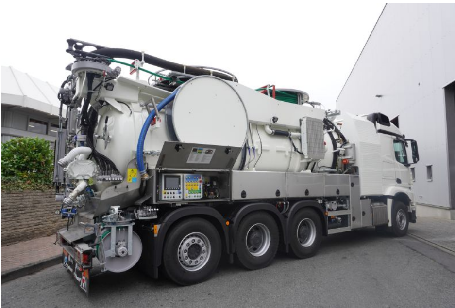
Ein FFG-Fahrzeug mit Wasseraufbereiter unter Höchstdruck (Bild: FFG).
