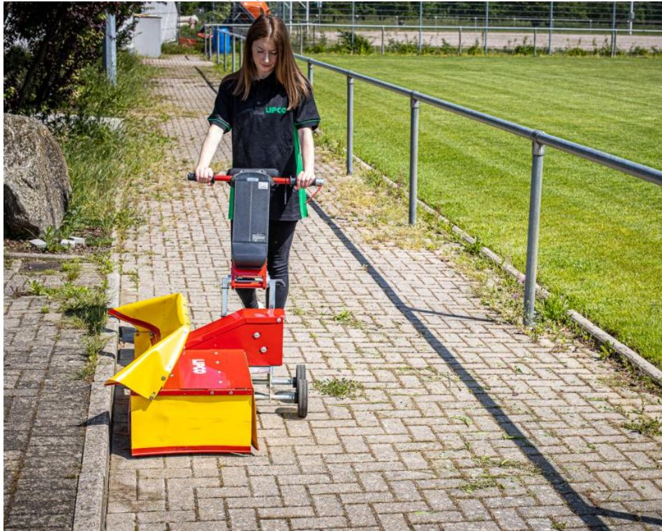
Durch eine geringe Fahrgeschwindigkeit drehen sich die Fadenköpfe wesentlich langsamer als bei einer Motorsense. Dadurch und zusammen mit der Schutzvorrichtung wird die Steinschlaggefahr deutlich reduziert (Bild: Lipco).
