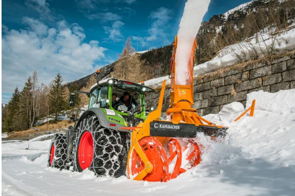
Ausgerichtet auf maximale Performance ist die »KFS 1150« die größte Anbau-Frässchleuder und damit bestens für die schwersten Schneeräumarbeiten gerüstet (Bild: Kahlbacher).
