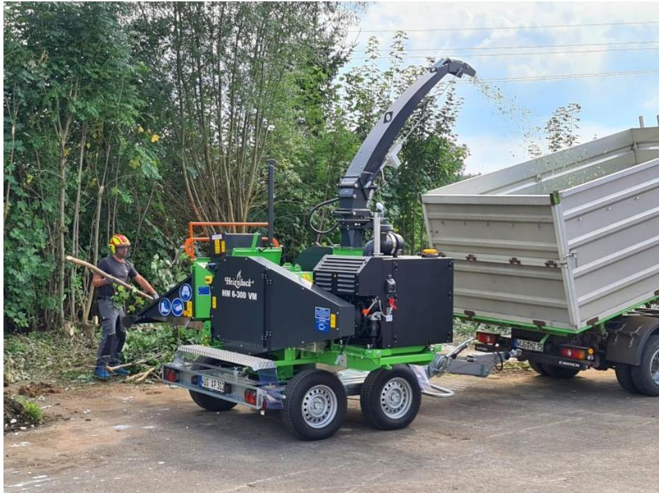
Die handbeschickte Trommelhackmaschine »Heizohack HM6-300 VM« ist auf einem Tandemfahrgestell montiert (Bild: Heizomat).
