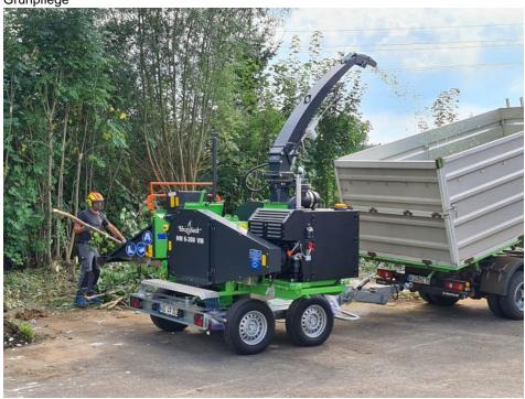
Die handbeschickte Trommelhackmaschine »Heizohack HM6-300 VM« ist auf einem Tandemfahrgestell montiert (Bild: Heizomat).
