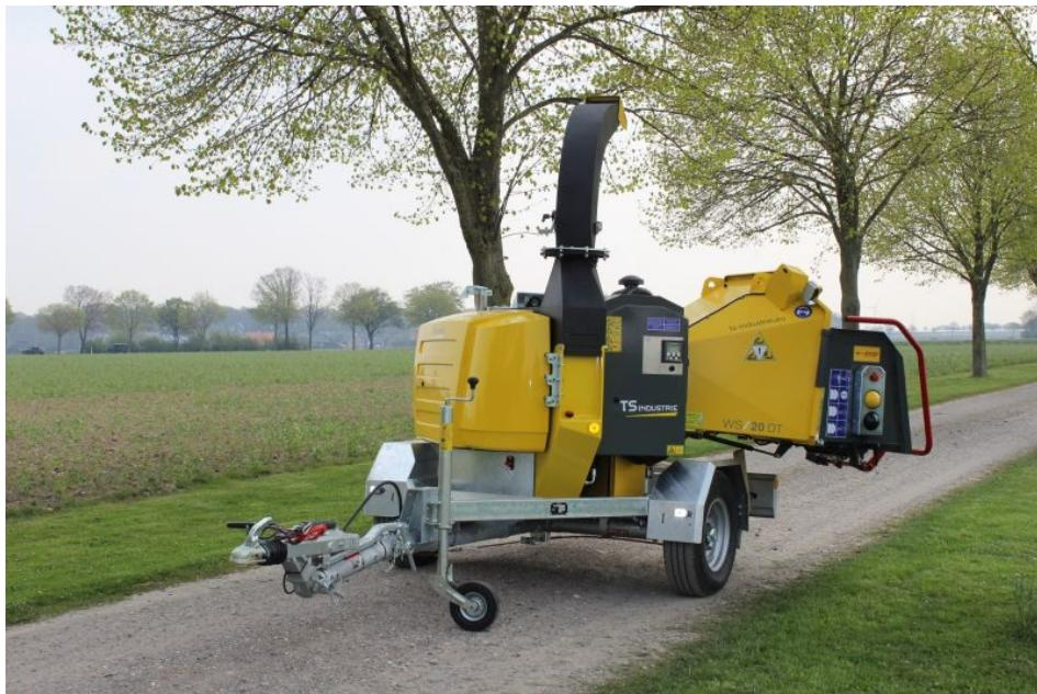
Ein Häcksler »WS/20 DT« steht bereit zum Einsatz, Steuerpult rechts an der Einwurföffnung (Bild: TS Industrie).
