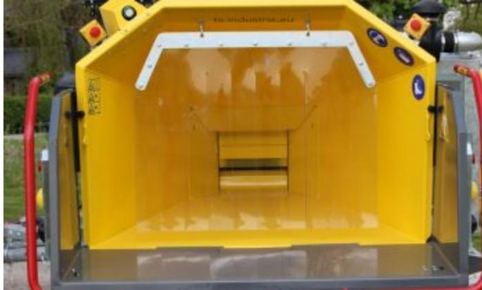
Der Bewegungssensor am oberen Rand (links) des Einwurftrichters hat einen breiten Erfassungsgrad und führt den Antrieb in den Leerlauf bzw. wieder auf Touren, wenn der Beschicker registriert wird (Bild: TS Industrie).
