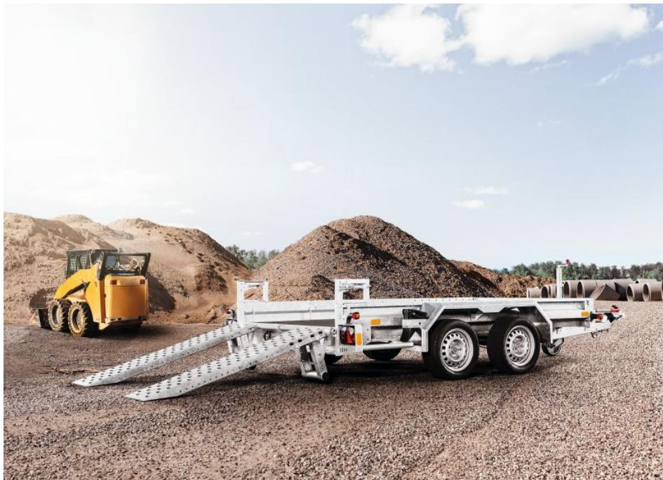
Der Anhänger ist wahlweise mit festen, klappbaren oder unterschiebbaren Auffahrtschienen ausgestattet (Bild: Böckmann).
