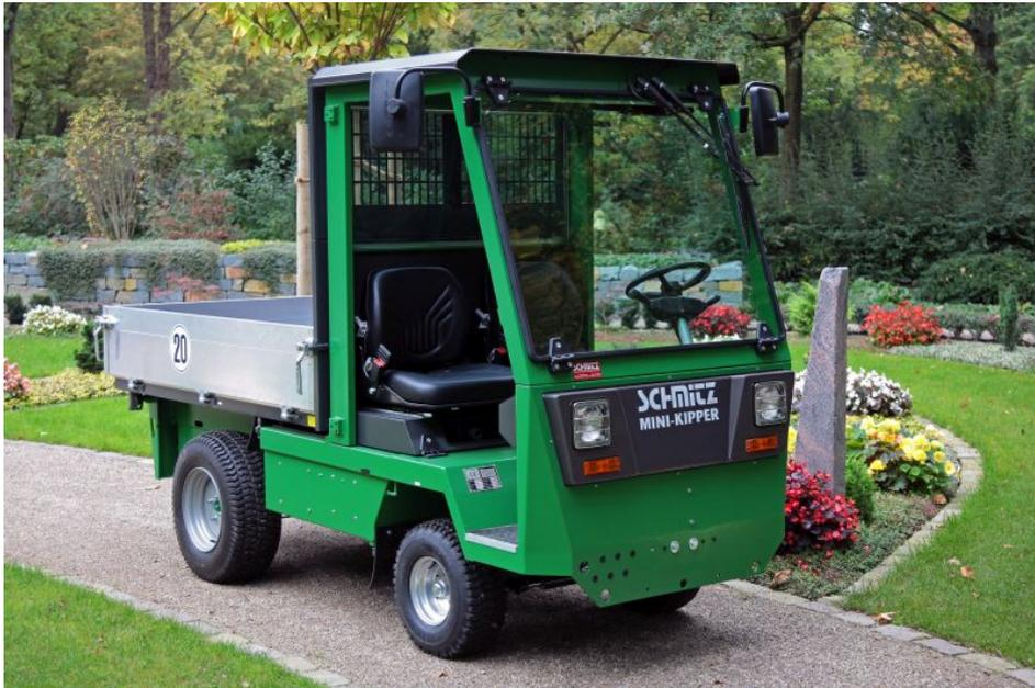
Wendig und leise auf Friedhöfen unterwegs – der elektrisch angetriebene Mini-Kipper »MK 1700E« (Bild: Schmitz).
