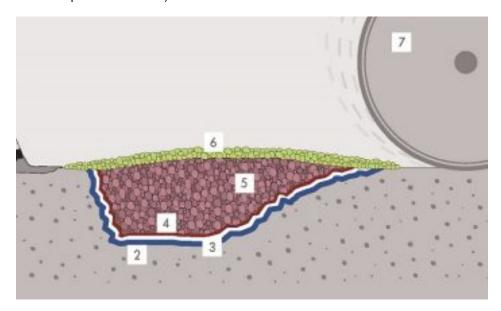
Die Schadstelle wird: 1. bewertet und markiert, 2. mit Wasser gereinigt, 3. mit Luft trocken geblasen, 4. mit Bindemittel angespritzt, um eine Haftbrücke herzustellen, 5. mit bitumenhaltiger Mischung ausgefüllt – bei tiefen Stellen mit 4 – 6 oder 2 – 10 mm, 6. eine Deckschicht mit 2 – 4 mm bitumenhaltiger Mischung aufgebracht, 7. durch den Straßenverkehr verdichtet, zusätzliche Verdichtung mit einer Walze/Gummirad, weitere Reduzierung des Rollsplitts (Bild: schäfer-technic).
