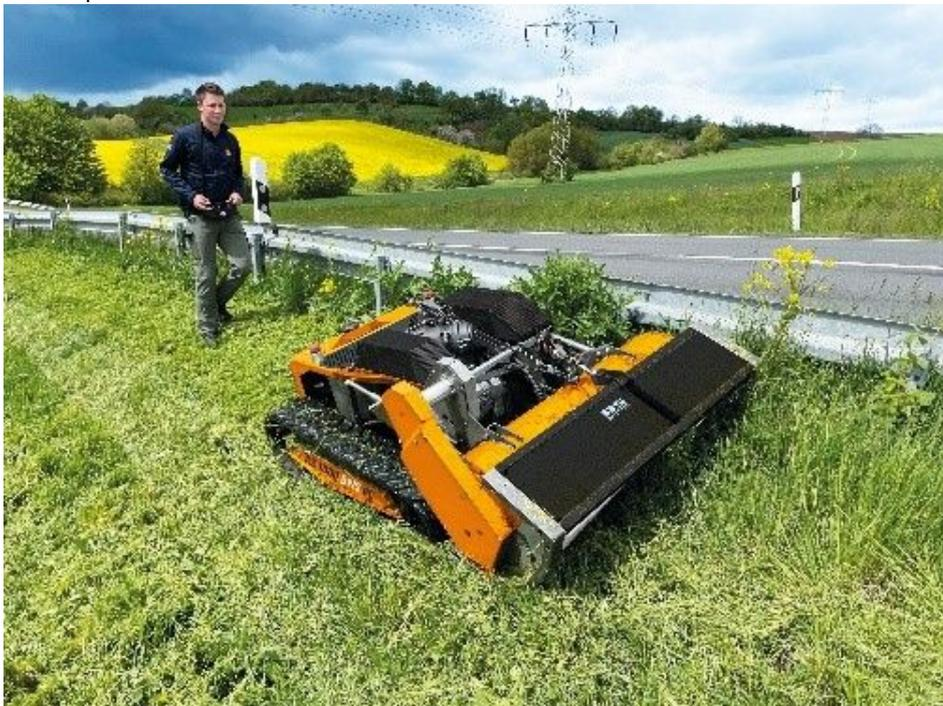
Mit dem neuen Schlegelmäher »AS 1000 Ovis RC« ist sicheres Mähen auch an extremen Steilhängen bis über 50 Grad kein Problem (Bild: AriensCo).
