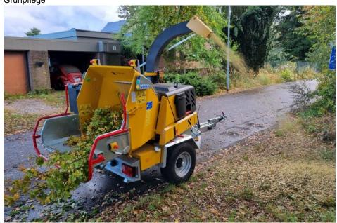
Auch bei den Arbeitsmaschinen geraten Abgaswerte mehr und mehr in den Fokus. Der mittelgroße Anhängerhacker »495 EX« für Durchmesser bis 24 cm erfüllt dank eines aktiven Partikelfilters die Abgasnorm Stage 5 (Bild: Schliesing).
