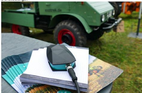
Telemetriemodul »T2« zur vollautomatischen Datenerfassung (Bilder: EXA Computing).
