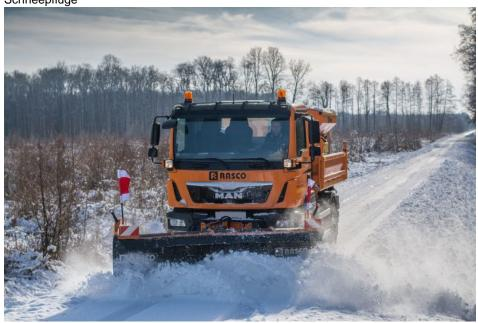
Der »MSP-L« ist für die Räumung kleinerer Schneemengen geeignet und wird daher für Gebiete mit milderen Wintern gewählt (Bild: Rasco).
