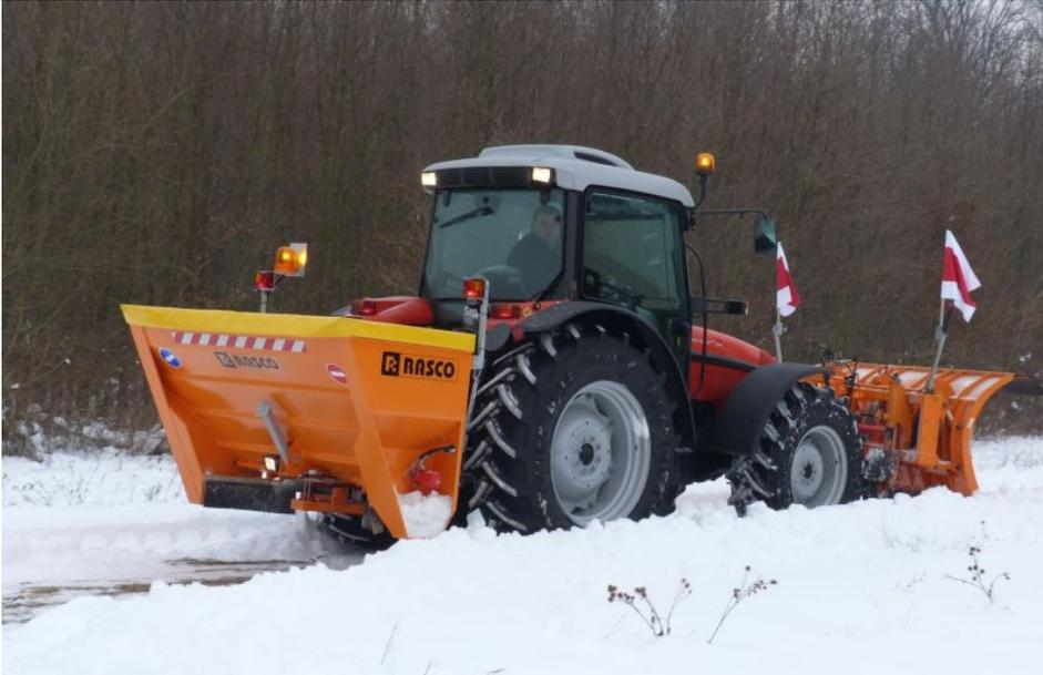
Traktorstreuer »TRP« mit einem Fassungsraum des Trockenstoffbehälters von 0,4 bis 1,5 m<sup>3</sup>. Optional gibt es auch einen zusätzlichen Feuchtmittelbehälter von 500 l (Bild: Rasco)
