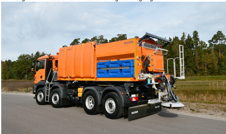
Kombistreueautomat »Icebear W« mit 10.500 l Sole und 6 m 3 Trockenstoff (Bild: Bucher Municipal).
