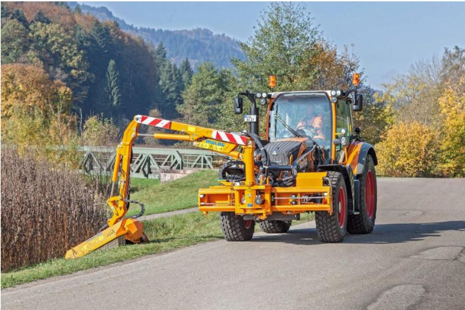
Frontauslegermähergerät »MFK 500« mit Mähkopf »MK 1200«, angebaut an einen Kommunaltraktor (Bild: Mulag).
