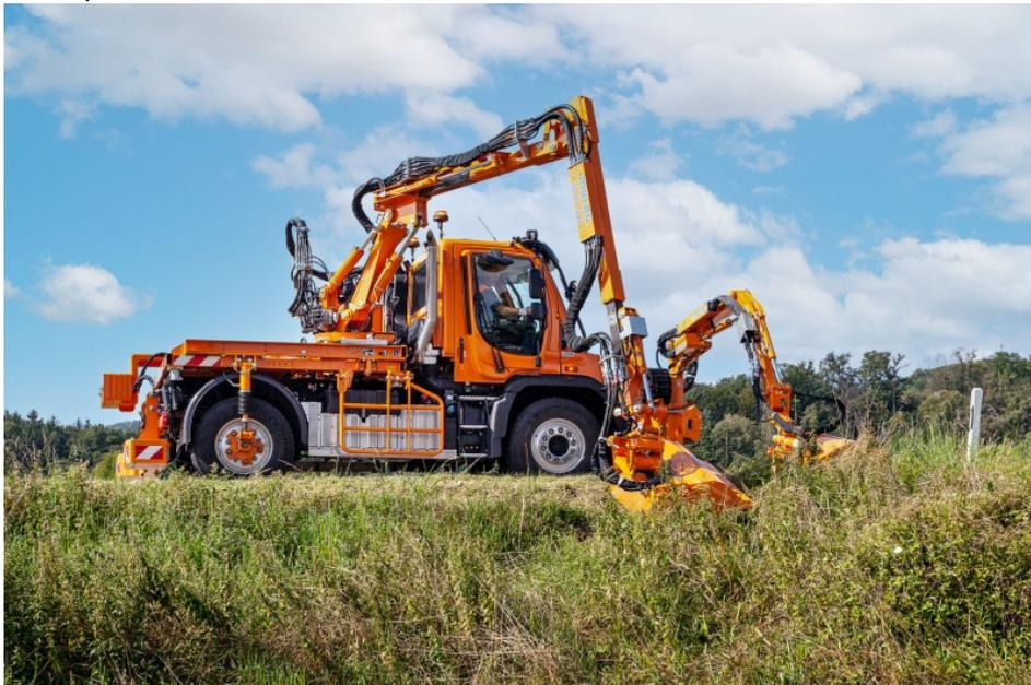
Mulag-Heckauslegermähergerät »MHU 900« im Kombibetrieb mit einem Frontauslegermähergerät »MFK 500« an einem Unimog (Bild: Mulag).
