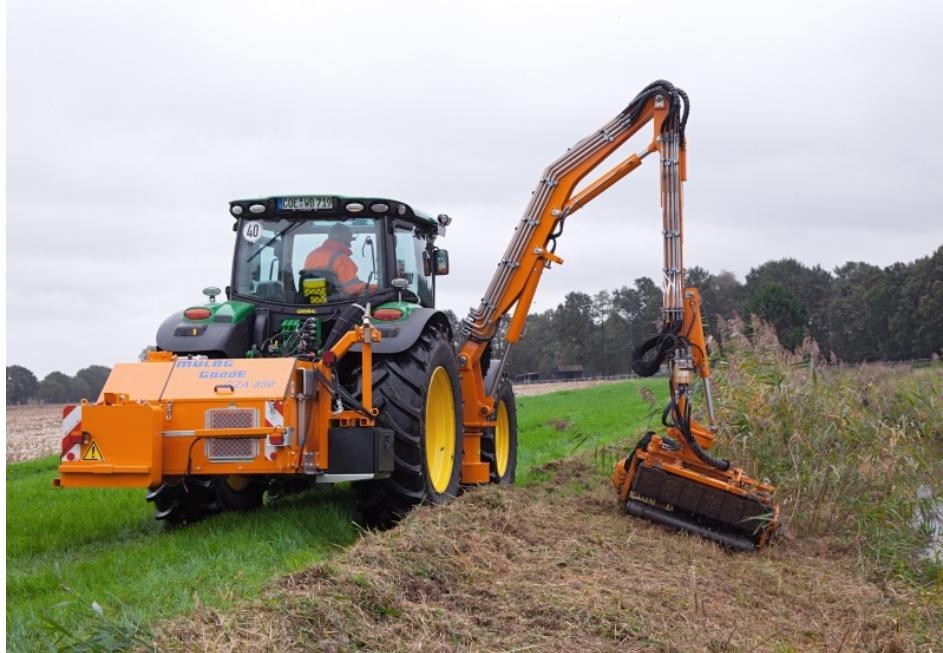
Der Gödde-Zwischenachsauslegermäher »GZA 850 S« hat eine Reichweite von 9,2 m ab Fahrzeugmitte und einen Schwenkbereich von 200° (Bild: Gödde).
