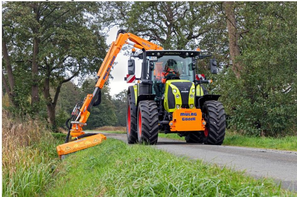
Der Heckausleger »GHA 700« mit einer maximalen Reichweite von 7,8 m ab Fahrzeugmitte bei Teleskopoption (Bild: Gödde).
