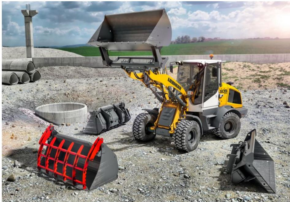
Dank »Likufix« ist ein effizienter und sicherer Wechsel zwischen verschiedenen hydraulischen Anbauwerkzeugen möglich (Bild: Liebherr).
