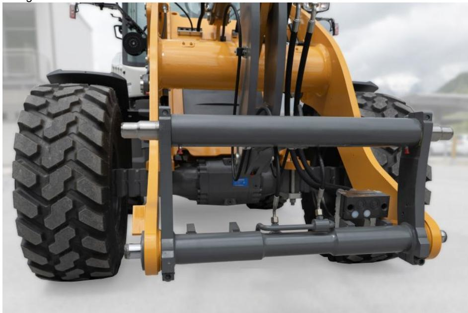
Wie hier bei einem »L 507 Stereo« zu sehen ist, ist die »Likufix«-Hydraulikkupplung sicher und robust am Schnellwechsler verbaut (Bild: Liebherr).
