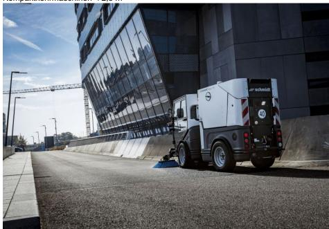
Die »Flexigo 150« mit einem 1,5 m³ großen Kehrgutbehälter verbindet hervorragende Kehreigenschaften sowie eine hohe Zuladung von einer Tonne mit den Vorteilen eines multifunktionalen Geräteträgers (Bild: Aebi Schmidt).
