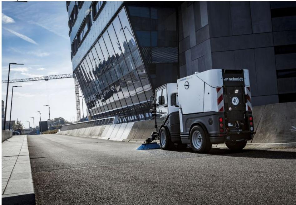
Die »Flexigo 150« mit einem 1,5 m<sup>3</sup> großen Kehrgutbehälter verbindet hervorragende Kehreigenschaften sowie eine hohe Zuladung von einer Tonne mit den Vorteilen eines multifunktionalen Geräteträgers (Bild: Aebi Schmidt).
