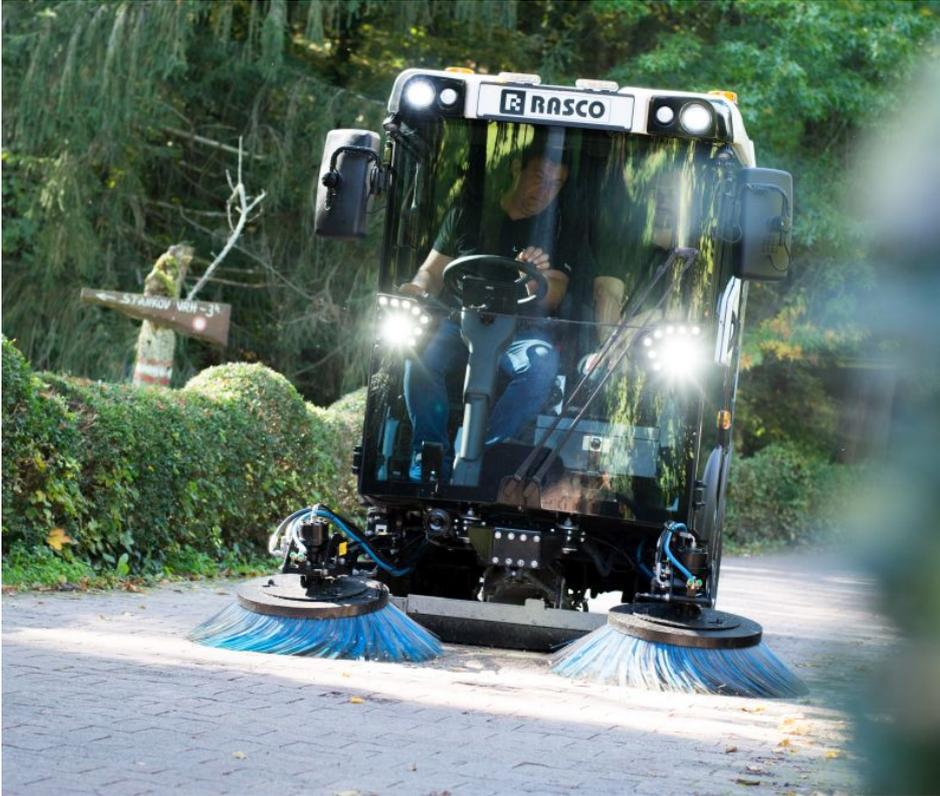
Die elektrische Kehrmaschinen ist mit einem 2- oder 3-Besensystem ausrüstbar (Bild: Rasco).
