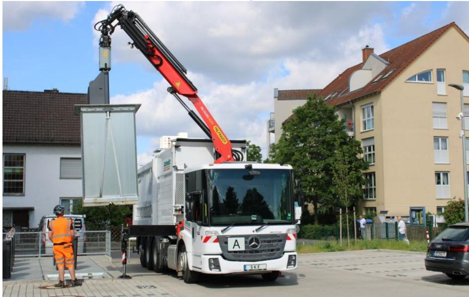
Ein »Hades« entsorgt per Ladekran den Inhalt von Unterflurbehältern (Bild: Schmidt Kommunalfahrzeuge).
