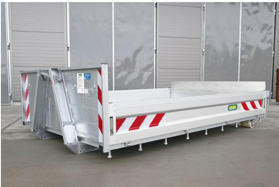
Die neue »City-Pritsche« ist in Längen von 3300 bis 4200 mm verfügbar (Bild: Unsinn).
