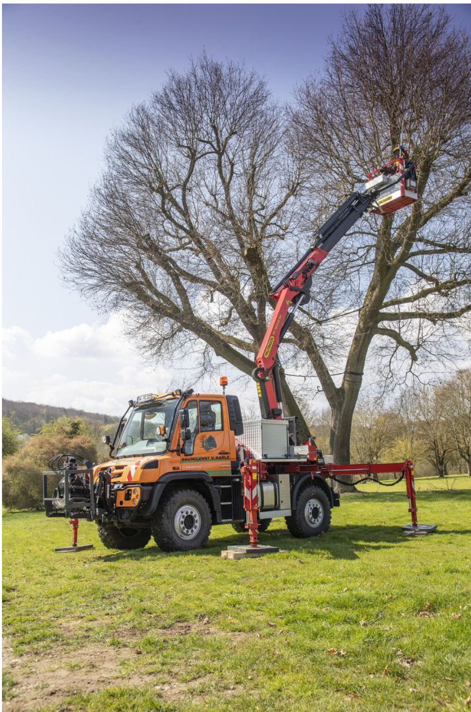
Der Unimog mit Hubarbeitsbühne bei Baumpflegearbeiten (Bild: Daimler Truck AG).
