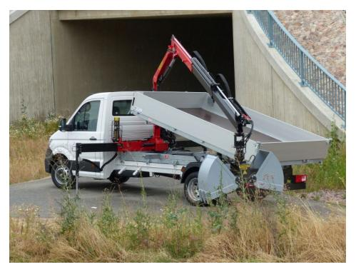
Kipperaufbau mit Palfinger-Kran auf VW Transporter T5 (Bild: Kunath).
