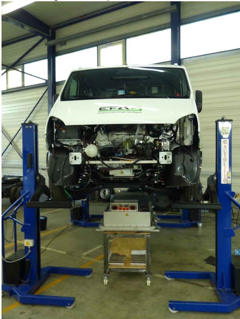
Einbau einer Fahrzeug-Batterie bei EFA-S (Bild: EFA-S GmbH).
