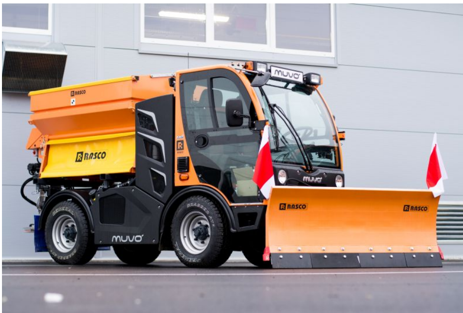
Der »Muvo« mit Streuer »Solid XM« und Schneepflug »Vertus M« . . . (Bild: Rasco).
