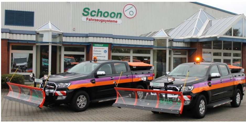
Ford Ranger mit Schoon Winterdienstpaket, bestehend aus Lexan-Schneeschild und Streuer (Bild: Schoon).
