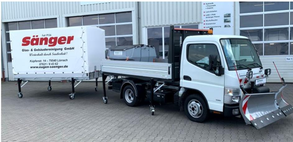
Mitsubishi Fuso mit Wechselaufbauten: Werkspritsche mit Winterdienst und Pritsche mit Plane (Bild: Schoon).
