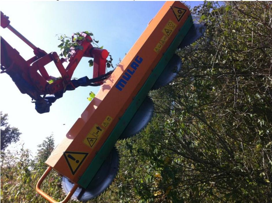
Die Astsäge wird mit Gehölzen bis 15 Zentimeter Durchmesser fertig (Bild: Oestreich und Fa. Springmann).
