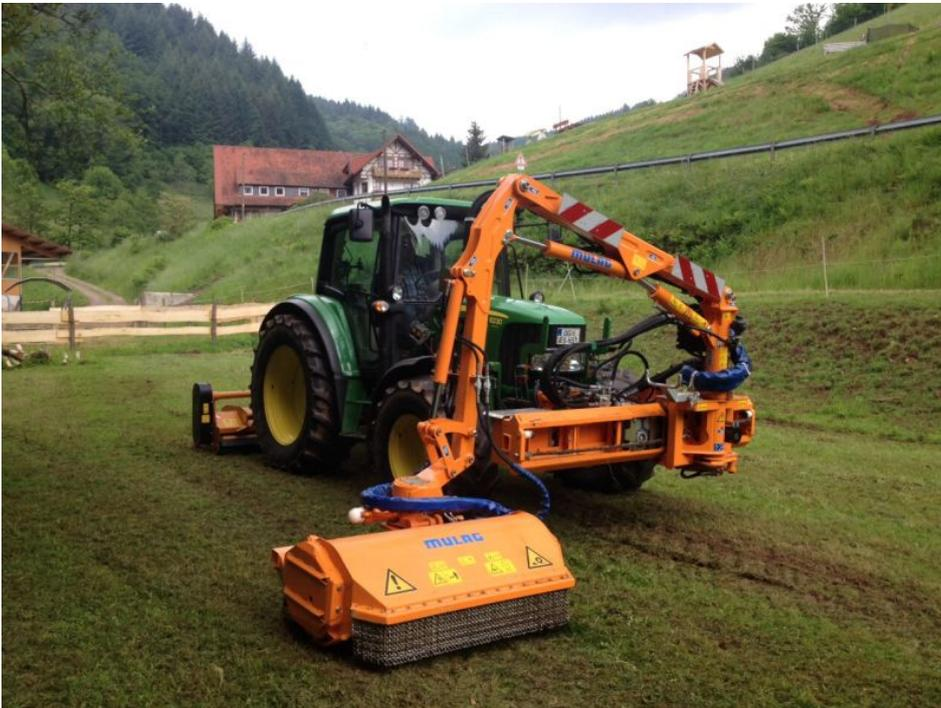
Auf gut befahrbaren Flächen sind die Schlepper mit zwei Mulchern gleichzeitig im Einsatz. Einer am Ausleger, ein weiterer an der rückseitigen Dreipunktbefestigung, so kommt man auf eine Arbeitsbreite von vier Metern (Bild: Oestreich und Fa. Springmann).
