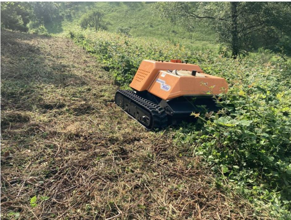
Die ferngesteuerte Mähraupe wird mit Dornhecken bis zu einer Höhe von 1,5 Metern fertig. Hänge mit einer Neigung bis zu 55 Grad können sicher befahren werden. Mit einer Geschwindigkeit von 8 km/h können Flächen bis zu 5000 qm/h bearbeitet werden (Bild: Oestreich und Fa. Springmann).
