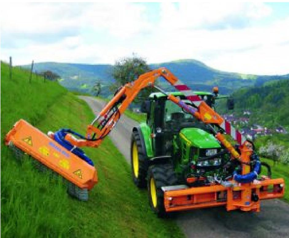
Böschungsmulchen mit John Deere »6230 Premium« in Verbindung mit dem Mulag Mulchkopf »MK 1200«. Der Ausleger ermöglicht einen Aktionsradius von sechs Metern (Bild: Oestreich und Fa. Springmann).
