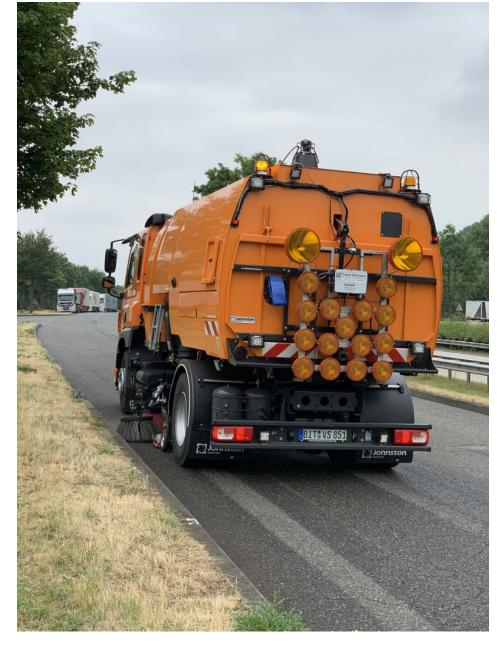
Die Kehrmaschine wird für die Reinigung der Fahrbahnen, Standspuren, Mittelstreifen sowie der Verkehrswege an den Autobahnraststätten eingesetzt (Bild: Thome-Bormann).
