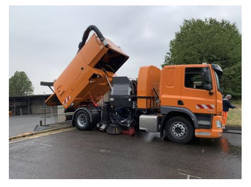
Dank der effizienten Abstimmung zwischen dem Allison-Getriebe und dem hydrostatischen Getriebe ist ein zusätzlicher Aufbauverbrennungsmotor überflüssig. Das führt zu geringeren Schadstoffemissionen, und zusätzlich kann durch das niedrigere Leergewicht des Fahrzeugs die Kehrgutnutzlast erhöht werden (Bild: Thome-Bormann).
