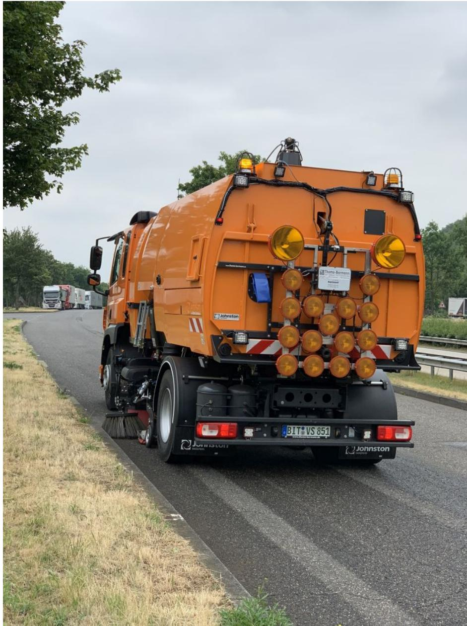
Die Kehrmaschine wird für die Reinigung der Fahrbahnen, Standspuren, Mittelstreifen sowie der Verkehrswege an den Autobahnraststätten eingesetzt (Bild: Thome-Bormann).
