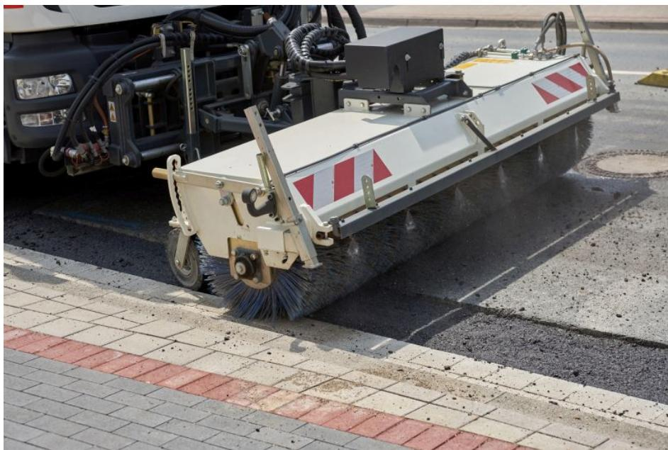
Gut erkennbar: Aus den Düsen spritzt Wasser zur Minderung der Staubentwicklung beim Kehren (Bild: schäfer-technic).
