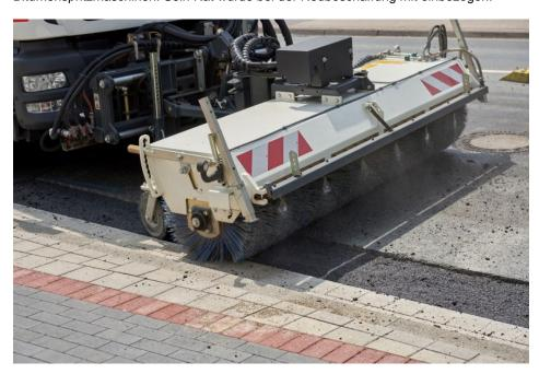
Gut erkennbar: Aus den Düsen spritzt Wasser zur Minderung der Staubentwicklung beim Kehren (Bild: schäfer-technic).
