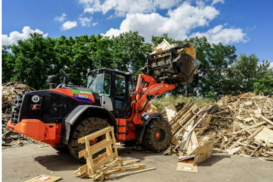
Hitachi-Radlader »ZW180-6« mit Highlift Z-Kinematik auf dem Holzplatz: 14,5-Tonner mit maximal 2,6 m<sup>3</sup> Schaufelvolumen und 129 kW Motorleistung (Bild: wyynot, Dietmar Puttins).
