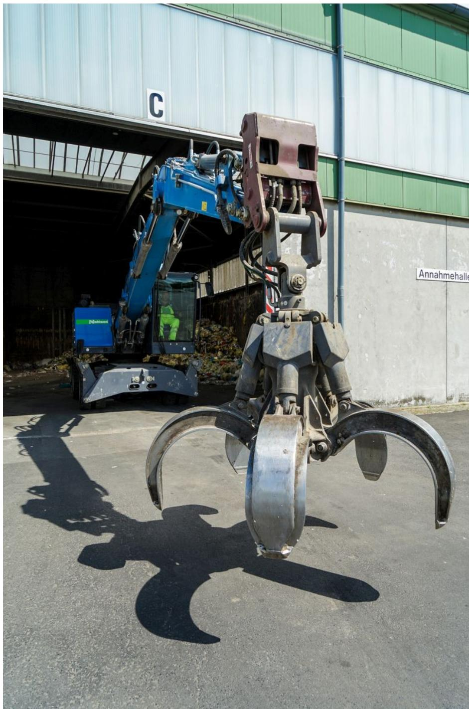
Der »Fuchs«-Bagger auf dem Weg zum Holzplatz: Mehrschalengreifer am vollhydraulischen »OilQuick«-Schnellwechsler »OQ 65« (Bild: wyynot, Dietmar Puttins).
