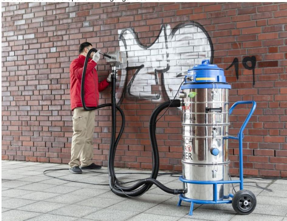
Das Reinigungs-System »Tornado ACS« ist in wenigen Minuten aufgebaut und einsatzbereit. Die Entsorgung von verschmutzten Reinigungsmitteln entfällt, da ohne Hochdruck, ohne Wasser und ohne Chemie gereinigt wird (Bild: Systeco).
