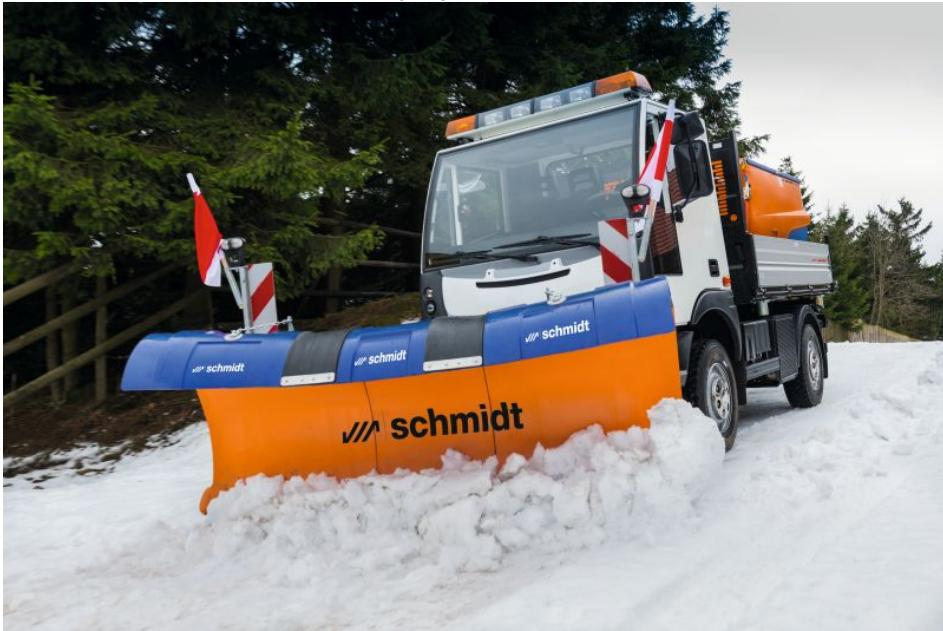
Der kompakte Geräteträger »MT« hier mit Schneepflug und Aufbaustreuer (Bild: Aebi Schmidt).
