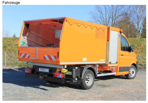
Schoon Müllsammler Kipper mit Halterungen für Handgeräte und einer »VariaBoxx« zwischen Kabine und Aufbau (Bild: Schoon).
