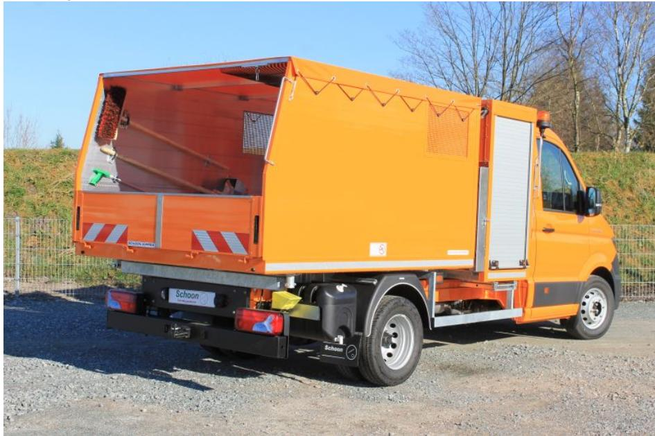
Schoon Müllsammler Kipper mit Halterungen für Handgeräte und einer »VariaBoxx« zwischen Kabine und Aufbau (Bild: Schoon).
