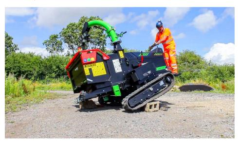
Der Raupenhäcksler »EVO 205 D SURE-Trak« meistert mit individuell schwenkbaren Ketten nahezu jedes Gelände (Bild: GreenMech).
