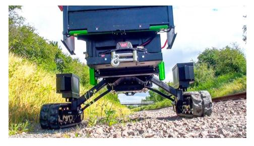
Eine beachtliche Bodenfreiheit bis zu 540 mm hat die Maschine (Bild: GreenMech).
