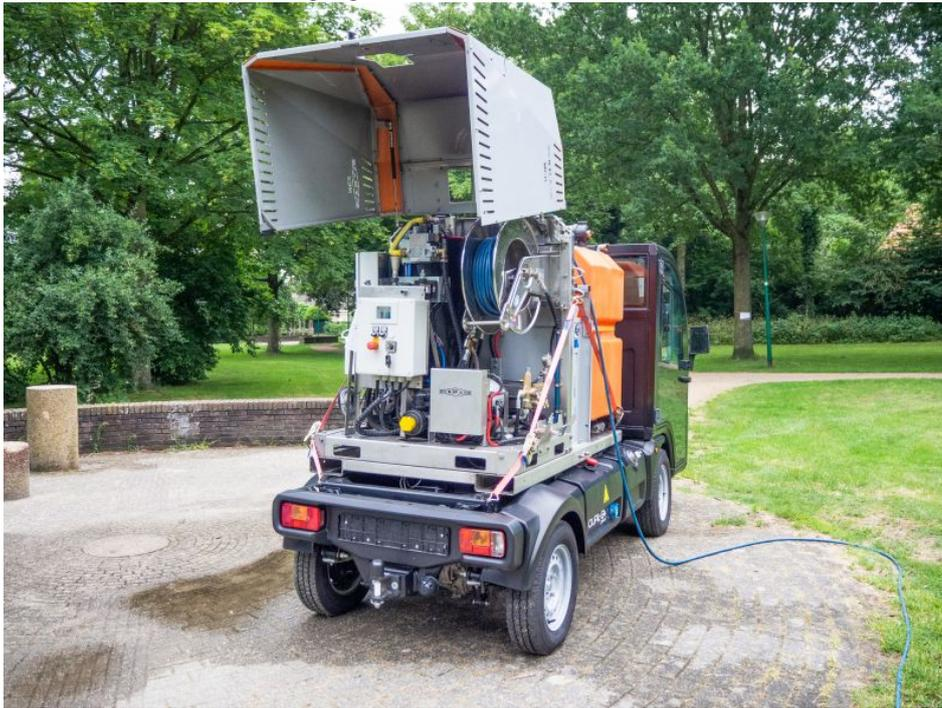
»MCB-30« Heißwassersystem auf einem Geräteträger mittels Schieberahmen (Bild: Empas).
