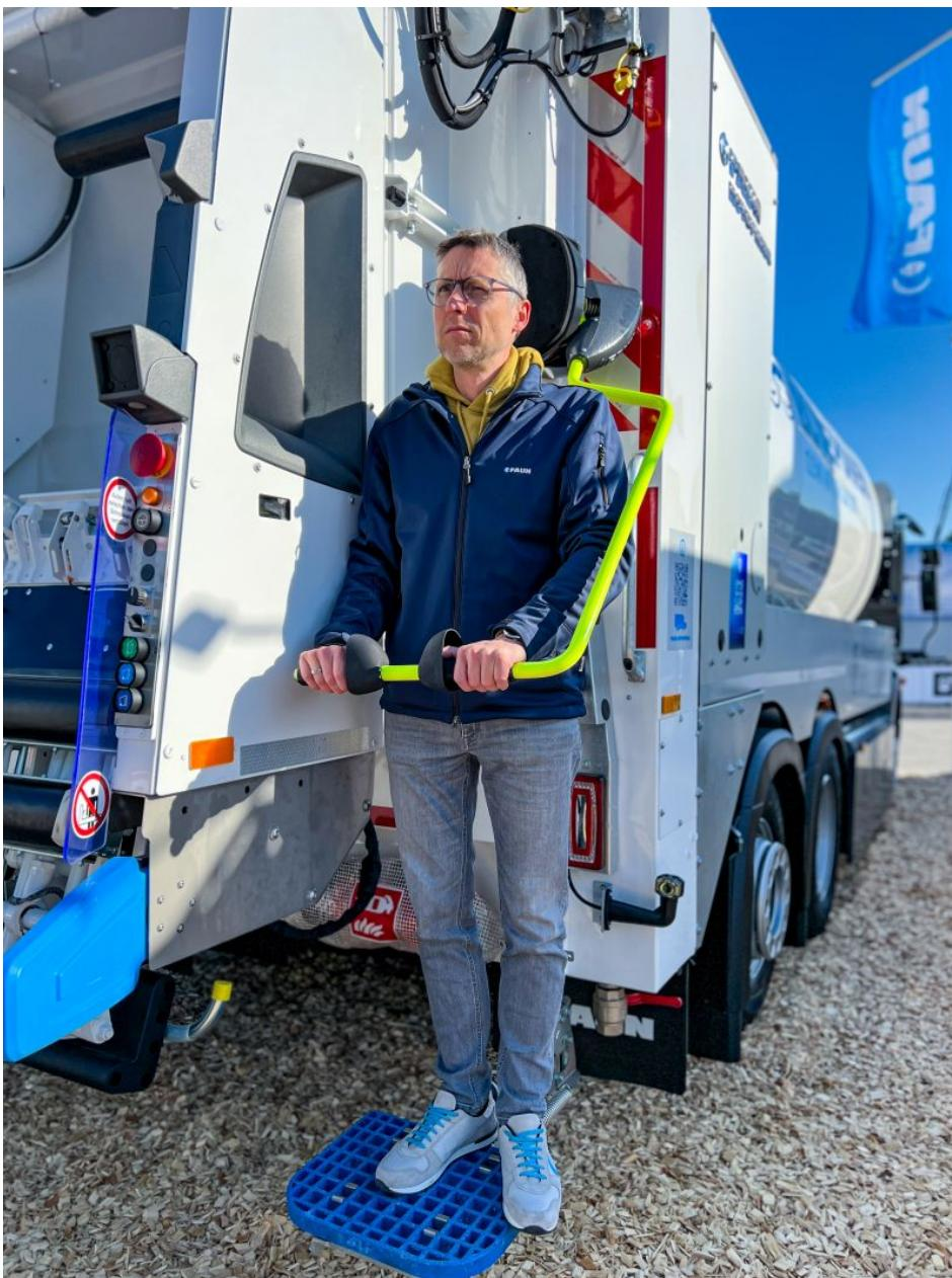
Mit dem Rückfahr-Sicherungs-System (RSS) kann der Bediener während der Rückwärtsfahrt auf dem Trittbrett mitfahren, ohne seine Sicherheit zu gefährden (Bild: Faun).
