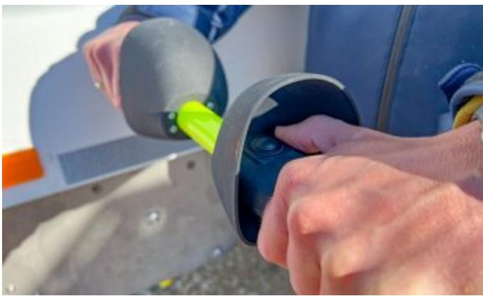
Über eine Taste kann das Fahrzeug in einer Gefahrensituation direkt gestoppt werden (Bild: Faun).
