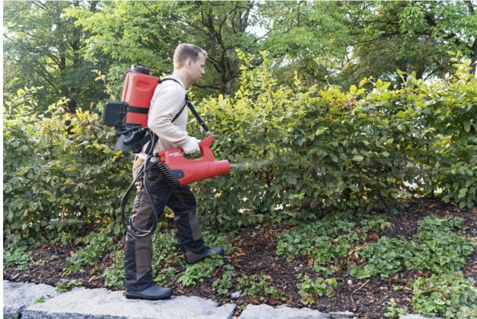
Die Sprühtropfen werden ideal in die Laubwand eingetragen und benetzen schonend die Blattober- und -unterseiten (Bild: Birchmeier).
