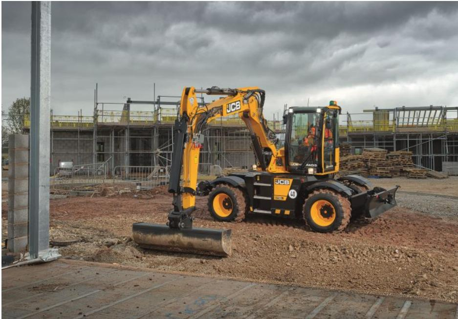
Der Motor des JCB »Hydradig« ist im Unterwagen verbaut. Dadurch hat der Fahrer eine optimale 360°-Rundumsicht auf das Arbeitsumfeld und alle Räder – ohne Hilfsmittel wie Kamera oder Spiegel (Bild: JCB)
