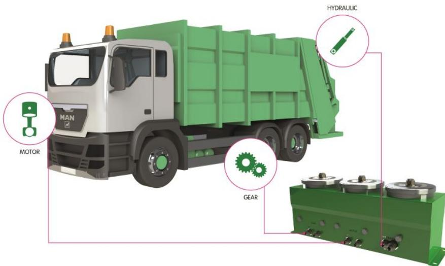
Mit der sogenannten »Triple Unit« von Kleenoil lassen sich die Motor-, Getriebe- und Hydraulikölkreisläufe mobiler Arbeitsmaschinen mit einheitlichen Elementen filtern (Bild: Kleenoil).
