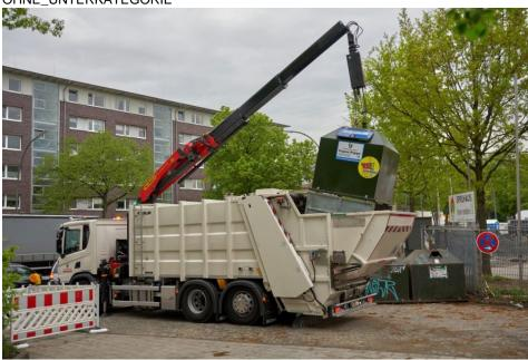
Bis zu viermal mehr Altpapier kann mit einem Pressbehälter Lkw gesammelt werden (Bilder: Zöller-Kipper).
